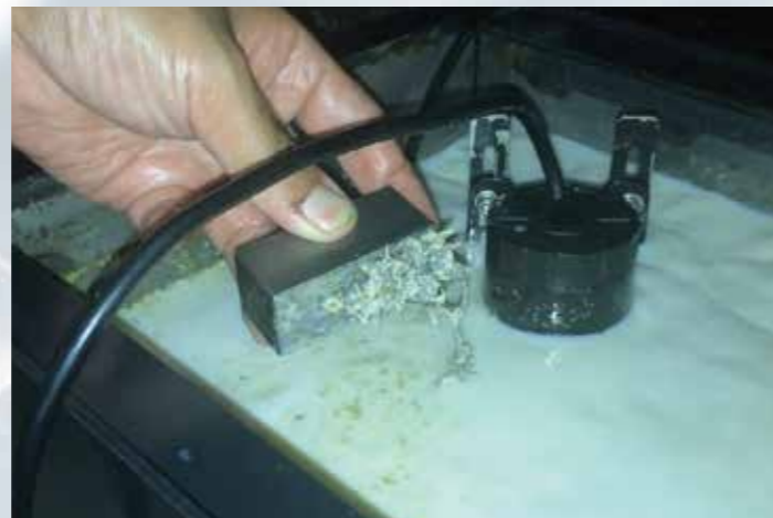
浮上した汚れに磁石を付けると、多くの金属粉がくっつきます。
